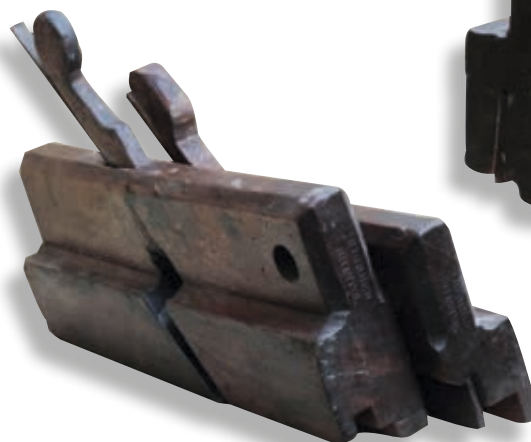
À gauche une paire de bouvets, dont l'un servait à faire la rainure et l'autre la languette. À droite se trouve le rabot à baguette.
